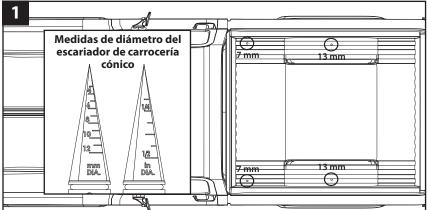
Utilizando los hoyuelos moldeados en la caja de la camioneta como guía, corte con cuidado dos orificios delanteros de 7 mm (0.275") y dos orificios traseros de 13 mm (0.5") en la caja con un escariador de carrocería cónico para dejar espacio para las protuberancias de los tornillos en la barra antivuelco y las estructuras (tenga en cuenta las medidas del diámetro del orificio en el escariador del cuerpo).
