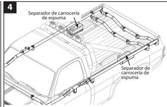
Retire los separadores de carrocería de espuma existentes (2) de las superficies planas de la caja del carrocería (parte inferior del carrocería) como se muestra, y luego retire el papel de la parte posterior de los nuevos separadores de carrocería de espuma y fíjelos en los mismos lugares. Vuelva a instalar el pestillo sin sujetadores.
