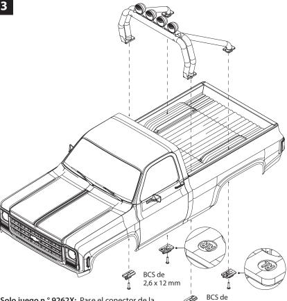
Solo juego n.º 9262X: Pase el conector de la barra de luces led a través del orificio perforado de 13 mm en el lado izquierdo (lado del conductor). Asegure la barra antivuelco al cuerpo de la camioneta como se muestra utilizando las estructuras de la barra antivuelco incluidas y los BCS de 2.6 x 12 mm (4).
